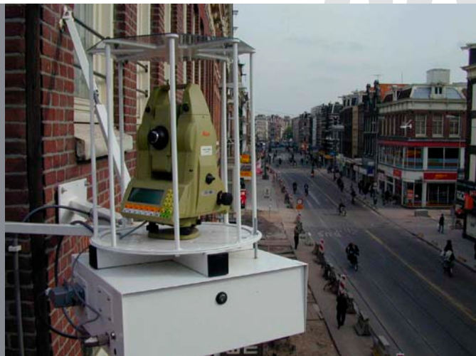
CYCLOPS installé prenant des mesures dans la ville d'Amsterdam. Chaque appareil est protégé contre le vandalisme. Image: SOL DATA
